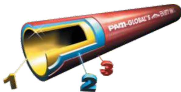
Рис. 14. Безрозтрубні труби PAM-GLOBAL® S (SML): 1 – епоксидна смола товщиною 130 мкм; 2 – чавун, метод Де Лаво; 3 – Акриловий лак товщиною 40 мкм
